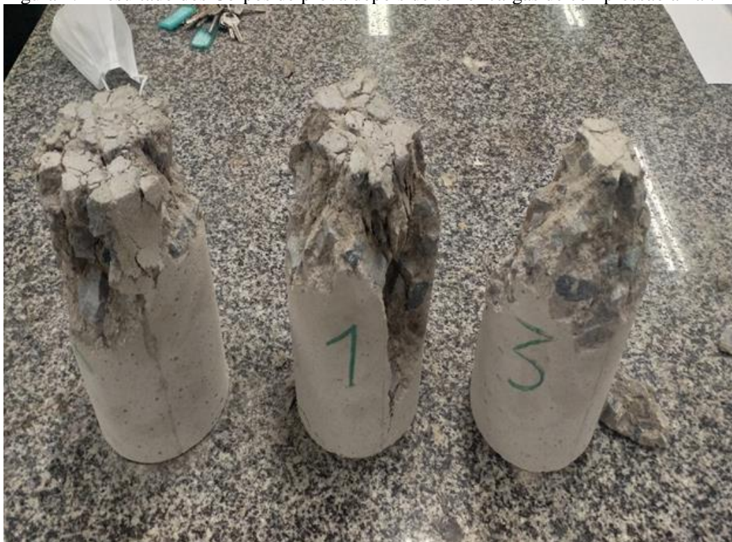
Figura 1. Resultado dos Corpos de prova depois de sofrer cargas de compressão axial.
